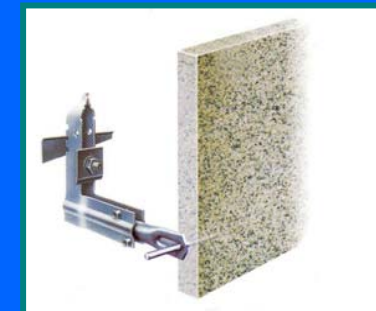
Fissaggio della lastra
